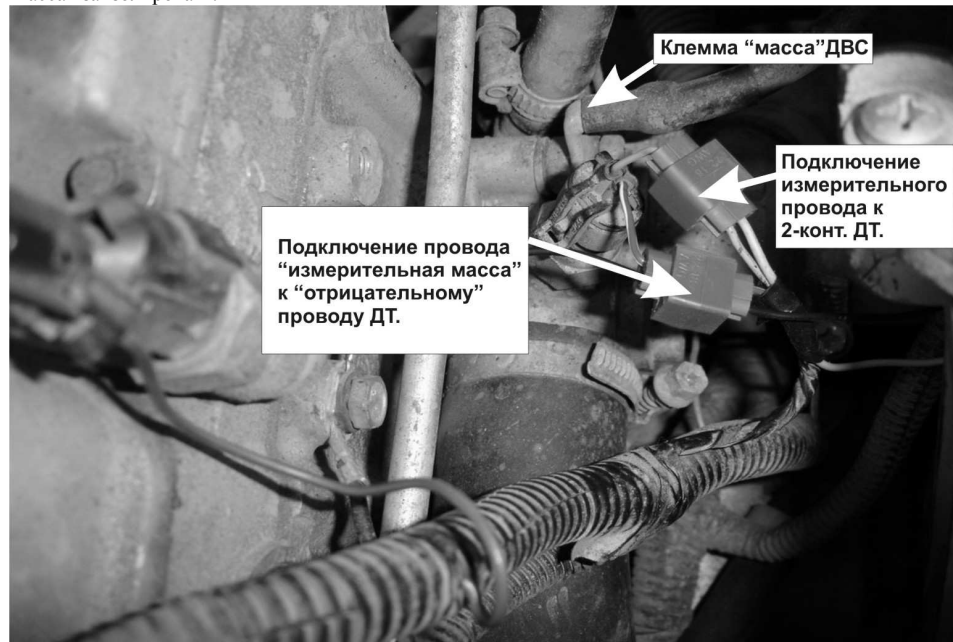
Рисунок А.3 – Подключение к двухконтактному ДТ
