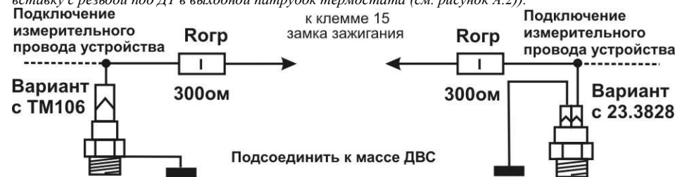
Рисунок А.2 – Схема подключения дополнительного ДТ
