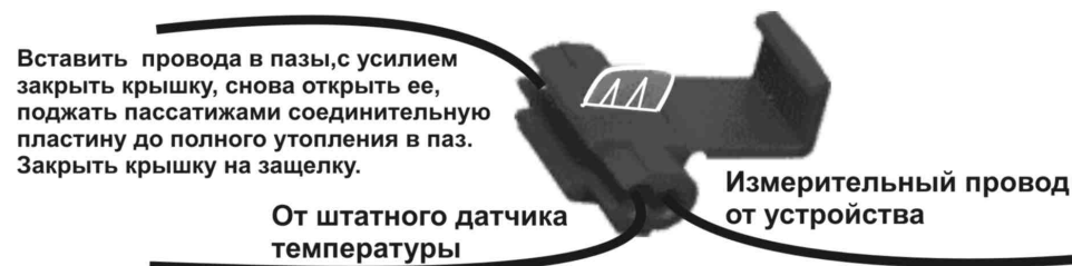
Рисунок 3 – Подключение измерительного провода к проводу ДТ
