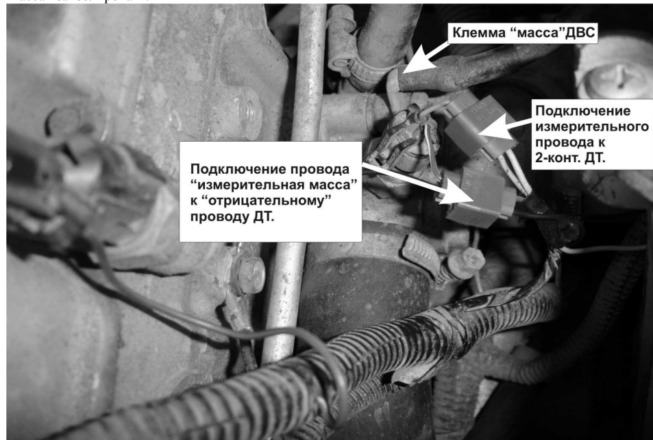
Рисунок А.3 – Подключение к двухконтактному ДТ
