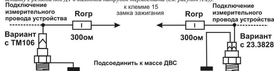
Рисунок А.2 – Схема подключения дополнительного ДТ
